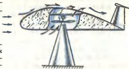
Рис. 3. У такого ветроагрегата концентрация энергии ветра осуществляется за счет крыла с отверстиями.
