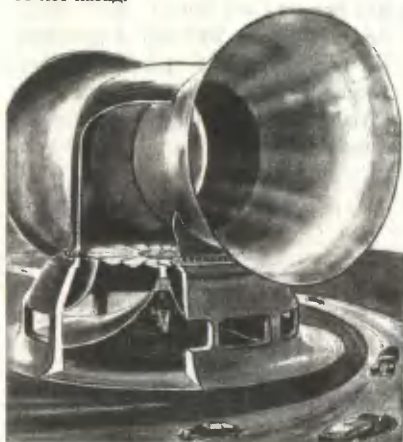
Рис. 2. Концентрация энергии ветра с помощью воронок или диффузоров приводит к довольно громоздким конструкциям. На рисунке один из таких проектов, предложенный П.Гроховским почти 60 лет назад.
